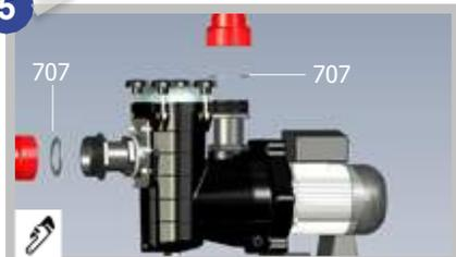
5. Positionner les joints 707 sur les raccords 19. Puis placer RENOVO® sur l'installation en utilisant et serrant les raccords existants **schématisés en rouge**.
