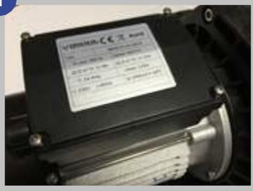
1. Dévisser les 4 vis du capot du bornier. Ouvrir le capot.
