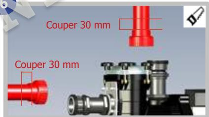
6. Sur l'installation existante (**schématisée en rouge**), couper les tuyaux 30mm après la base du raccord existant.
