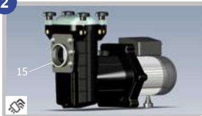
2. Placer la bride 15 avec le trou d'aspiration vers le bas (étiquette N°15 vers le haut) et approcher les 6 vis (**sans serrer**) sur le corps.
