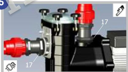
5. Serrer définitivement les 6 vis de bride sur l'aspiration et les écrous 17 sur le refoulement à l'aide d'une pince multiprise ou d'un autre outil adapté.
