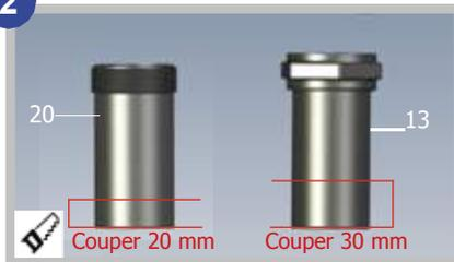
2. Couper 20mm sur le raccord 20 destiné au refoulement et 30mm sur le raccord 13 destiné à l'aspiration.
