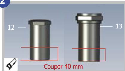
2. Couper 40mm sur le raccord 12 et le raccord
