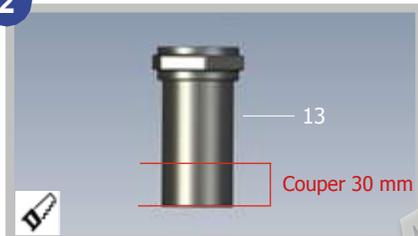
2. Couper 30mm sur le **raccord 13** destiné au **refoulement**.
