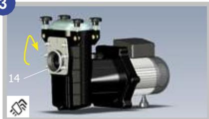
3. Dévisser les 6 vis de bride. Replacer la bride 14 avec le trou d'aspiration vers le bas (étiquette N °14 vers le haut) et approcher les 6 vis (**sans serrer**) sur le corps.
