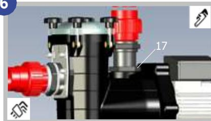
6. Serrer définitivement les 6 vis de bride sur l'aspiration et l'écrou 17 sur le refoulement à l'aide d'une pince multiprise ou d'un outil adapté.
