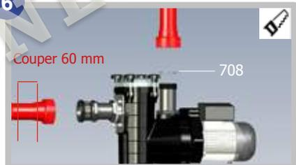
6. Sur l'installation existante (**schématisée en rouge**), couper 60mm sur le tuyau de l'aspiration à partir de la base du raccord existant. Placer le joint 708 sur le raccord 20.
