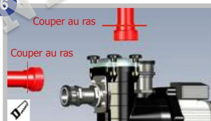
6. Sur l'installation existante (**schématisée en rouge**), couper les tuyaux au ras de la base du raccord existant.
