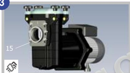
3. Placer la bride 15 avec le trou d'aspiration vers le bas (étiquette N°15 en haut) et approcher les 6 vis (**sans serrer**) sur le corps.
