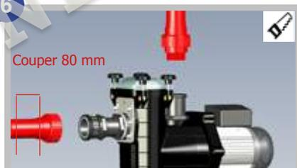
6. Sur l'installation existante (**schématisée en rouge**), couper 80mm sur le tuyau de l'aspiration à partir de la base du raccord existant.
