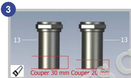
3. Couper **30 mm** sur un raccord n°13 destiné à l'**aspiration**. Couper **20 mm** sur le second raccord n°13 destiné au **refoulement**.
