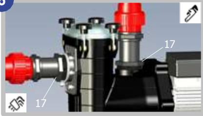
6. Serrer définitivement les 6 vis de bride sur l'aspiration et les écrous 17 sur le refoulement et l'aspiration à l'aide d'une pince multiprise ou d'un autre outil adapté.
