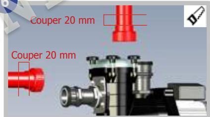
6. Sur l'installation existante (**schématisée en rouge**), couper les tuyaux 20mm après la base du raccord existant.
