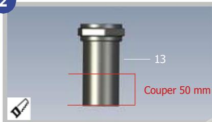
2. Couper **50mm** sur le raccord 13 destiné au **refoulement**.
