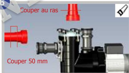
6. Sur l'installation existante (**schématisée en rouge**), couper le tuyau 50mm après la base du raccord existant sur l'aspiration. Couper au ras du raccord existant sur le refoulement.
