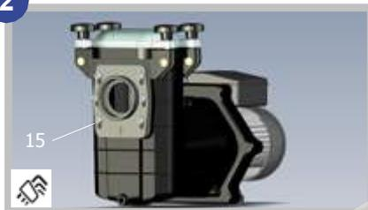
2. Placer la bride n°15 avec le trou d'aspiration vers le haut (étiquette N°15 vers le bas) et approcher les 6 vis (**sans serrer**) sur le corps.
