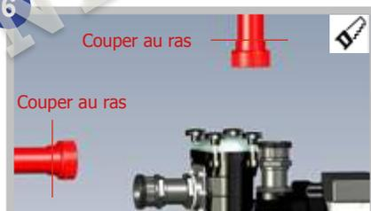
6. Sur l'installation existante (**schématisée en rouge**), couper le tuyau du refoulement au ras de la base du raccord existant.
