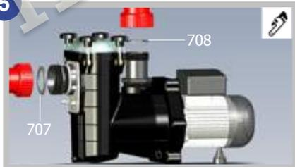
5. Positionner RENOVO® sur l'installation, sans oublier les joints 708 sur le refoulement et 707 à l'aspiration. Serrer les raccords existants (**schématisés en rouge**) sur les raccords 20 et 22.
