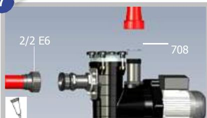
7. Sur le tuyau d'aspiration, décaper les pièces à encoller grâce à du décapant PVC. Puis coller les réactions et les manchons avec l'écrou du raccord E6 à l'aide d'une colle PVC adaptée.
