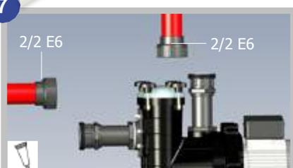
7. Sur ces tuyaux, décaper les pièces à encoller grâce à du décapant PVC. Puis coller les réductions, les manchons avec écrous des raccords E6 à l'aide d'une colle PVC adaptée.
