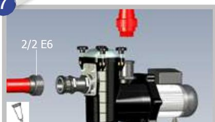
7. Sur le tuyau d'aspiration, décaper les pièces à encoller grâce à du décapant PVC. Puis coller les manchons avec l'écrou du raccord E6 à l'aide d'une colle PVC adaptée.
