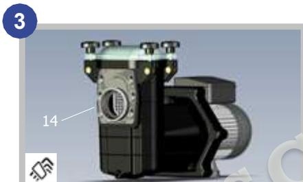
3. Dévisser les 6 vis de bride. Replacer la bride n°14 avec le trou décentré vers le bas et approcher les 6 vis (**sans serrer**) sur le corps.
