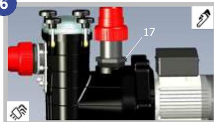
6. Serrer l'écrou 17 sur le refoulement à l'aide d'une pince multiprise ou d'un autre outil adapté. Serrer les 6 vis de bride sur l'aspiration.
