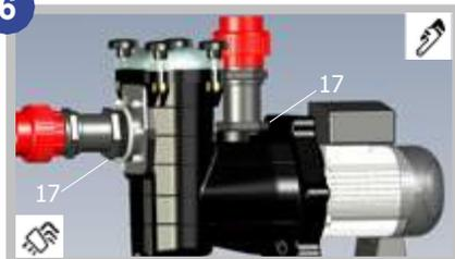
6. Serrer définitivement les 6 vis de bride sur l'aspiration et les écrous 17 sur le refoulement à l'aide d'une pince multiprise ou d'un autre outil adapté.
