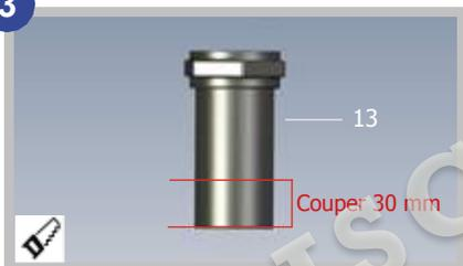
3. Couper **30mm** sur le raccord 13 destiné à l'**aspiration**. Ne pas couper le raccord 13 destiné au refoulement.
