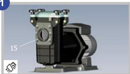
1. Placer la bride n°15 avec le trou d'aspiration vers le bas (étiquette N°15 vers le haut) et approcher les 6 vis (**sans serrer**) sur le corps.
