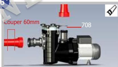
6. Sur l'installation existante (**schématisée en rouge**), couper le tuyau du refoulement au ras de la base du raccord existant. Placer le joint 708 sur le raccord 20.
