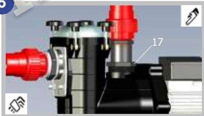
5. Serrer définitivement les 6 vis de bride sur l'aspiration et l'écrou 17 sur le refoulement à l'aide d'une pince multiprise ou d'un outil adapté.
